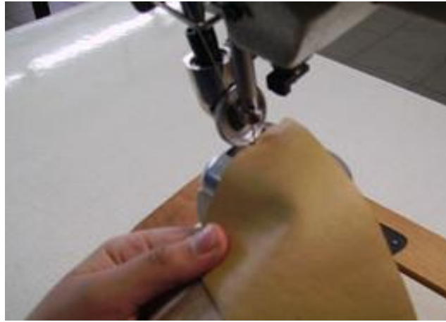
b: Rodanın yanlış yönü Resim 2.1: Rodanın yönü
